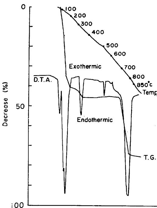
Fig. 1. TG-DTA curves of  $\text{FeSO}_4 \cdot 7\text{H}_2\text{O}$
