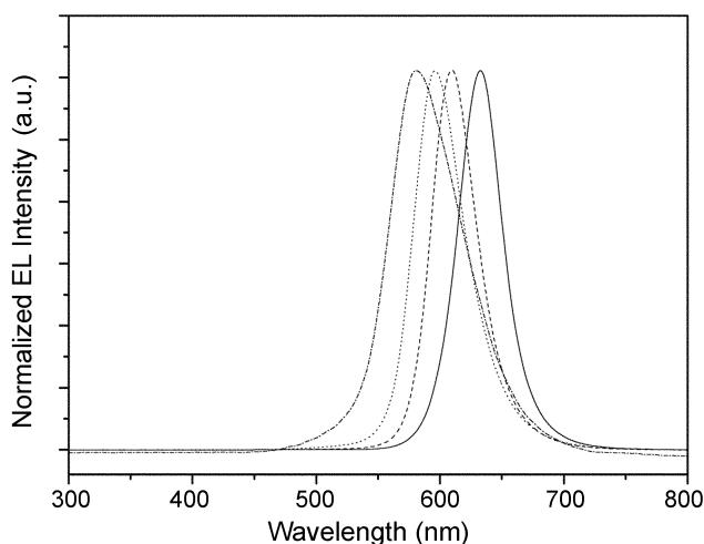
**Figure 4.** Normalized EL spectra of red device, Al(200 nm)/2-TNATA(60 nm)/NPB(15 nm)/Alq<sub>3</sub> + 3% DCM2\_(30 nm)/Alq<sub>3</sub>(30 nm)/LiF(1 nm)/Al(20 nm). Detection angle: (—): 0°, (---): 30°, (···): 60°, (- - -): 90°.
