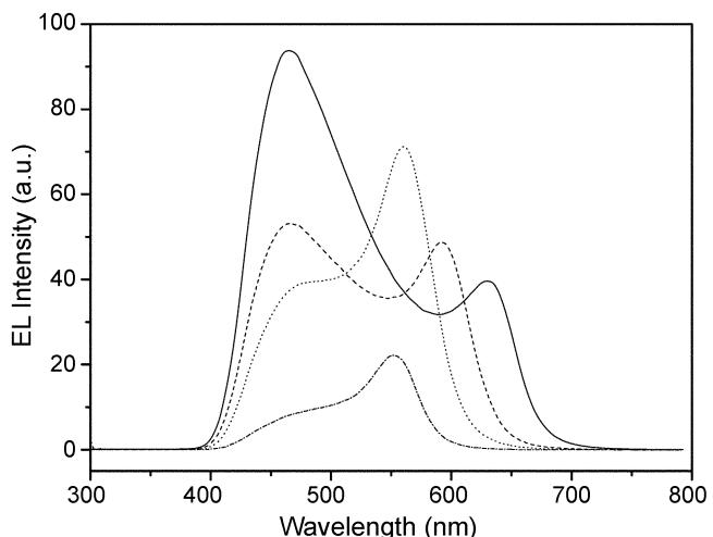
**Figure 5.** EL spectra of blue device, Al(200 nm)/2-TNATA(60 nm)/NPB(15 nm)/DPVBi(30 nm)/Alq<sub>3</sub>(30 nm)/LiF(1 nm)/Al(20 nm). Detection angle: (—): 0°, (---): 30°, (···): 60°, (- - -): 90°.
