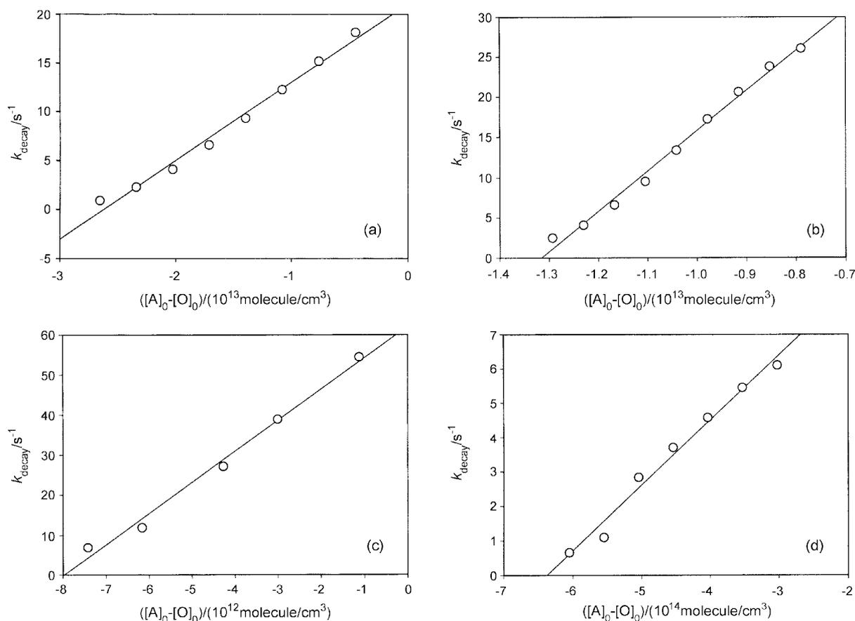
**Figure 4.** Plot of the second-order decay rate coefficient,  $k_{\text{decay}}$ , versus  $[sample]_0 - [O]_0$  at 298 K: (a)  $C_2H_4$ ; (b)  $CF_3I$ ; (c)  $CH_3I$ ; (d)  $CHBrCl_2$ .
